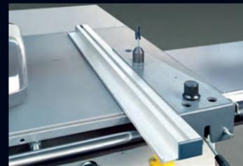
Standaard parallelaanslag met micrometrische fijnregeling, omklapbaar voor smalle snedes met schuingesteld zaagblad.
