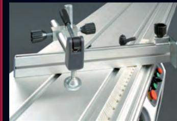
Table support avec butée et graduation, équipement standard sur la machine.
