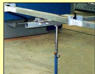
Extra ondersteuning lengte-aanslag voor langere lengtes
