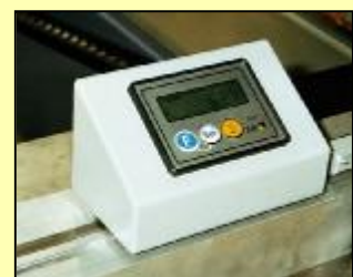
Electronisch digitale aflezing positie lengte aanslag
