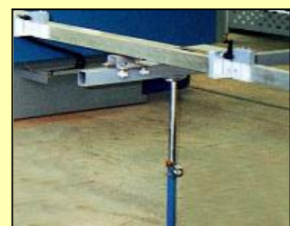
Extra ondersteuning lengte-aanslag voor langere lengtes
