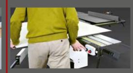
Höhenverstellung des Hobeltisches über Handrad und integriertem mechanische Ablesung, bieten Ihnen noch mehr Bedienkomfort und Präzision.
