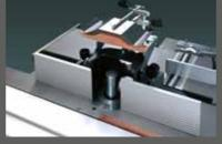
Mit der Tersa Dreimesser Hobelwelle mit Schnellspannung sparen Sie Zeit beim Messereinstellen
