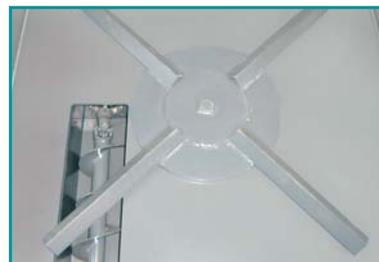
Het continu draaiende roerwerk mengt het materiaal en transporteert het naar de afvoer schroeftransporteur, welke het materiaal naar het persmechaniek voert.
