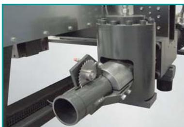
Met de briketlengte - automaat kan de lengte van de briketten ook bij verschillende materialen constant gehouden worden.
