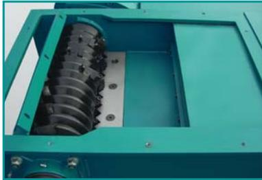
Door middel van de standaard gemonteerde schuif wordt het materiaal tegen de rotor gedrukt. De afstrijder verhindert dat dun materiaal zich tussen de schuif en de machinetafel klemt.
