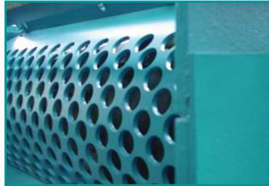
De grootte van de spanen wordt bepaald door de perforatie van de gemonteerde zeef. De grootte van de perforatie is afhankelijk van de verdere verwerking van de spanen.
