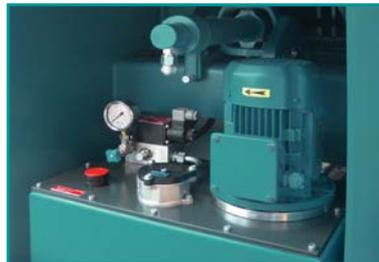
Het hydraulisch aggregaat is volledig in het machineframe geïntegreerd. De hydraulische cilinder is cardanisch gelagerd, waardoor een lange levensduur gegarandeerd is.
