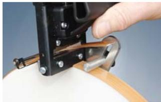
Kappgerät an der Kante anschlagen. Überstehende Kante durch das Kappgerät schieben.
