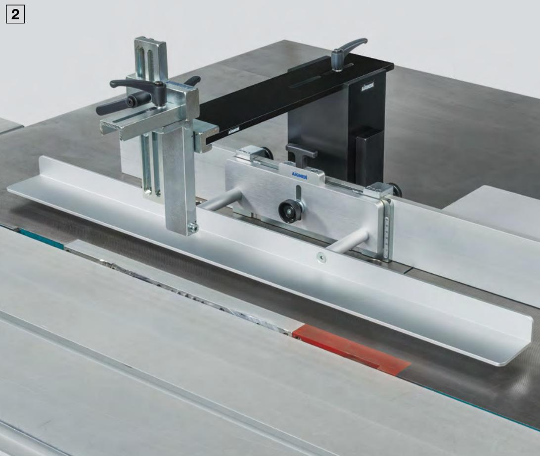
**1** Plaque-Support placée sur la Colonne de fixation côté court vers le Module-Presseur
