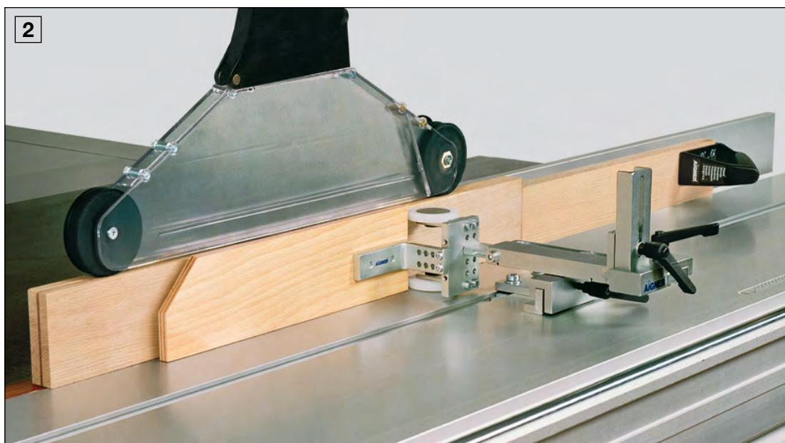
**1** Équerre de fixation avec Module-Presseur
