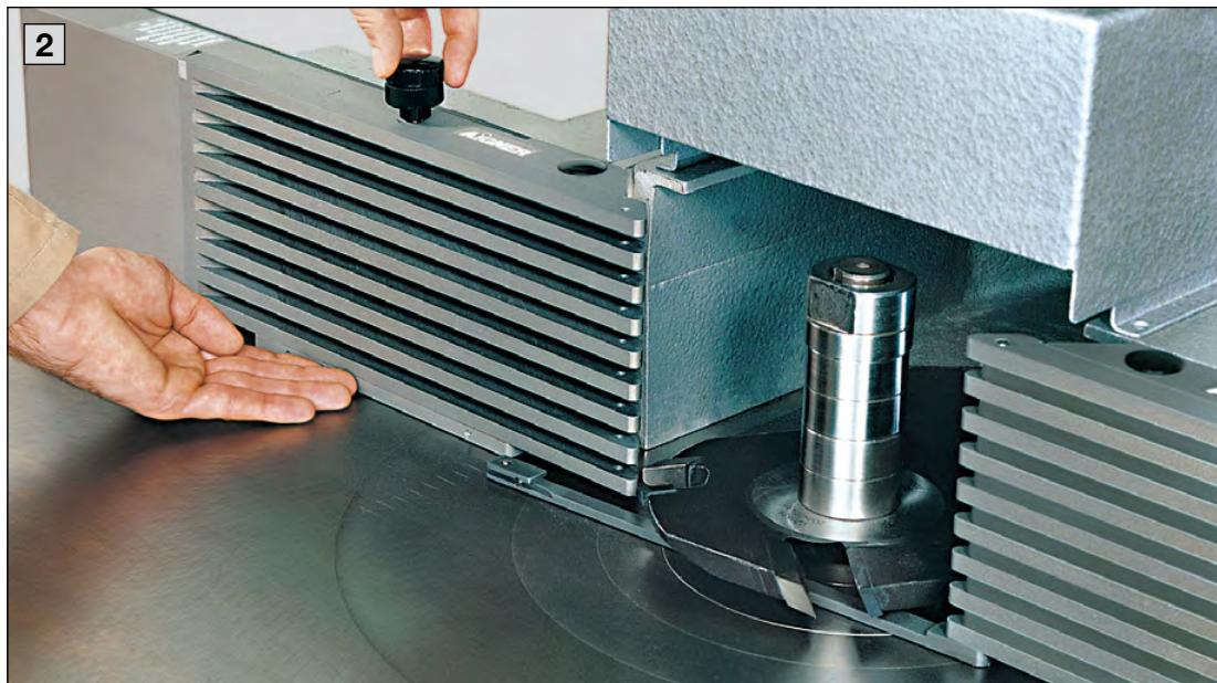
**1** Mise en place de la Barre de treillis dans l'évidement inférieur de la cassette gauche.
