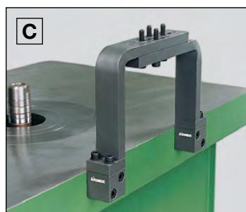
**1** Centrex mit Haltebrücke auf dem Maschinentisch montiert – Anschlaggehäuse nicht ausreichend stabil.
