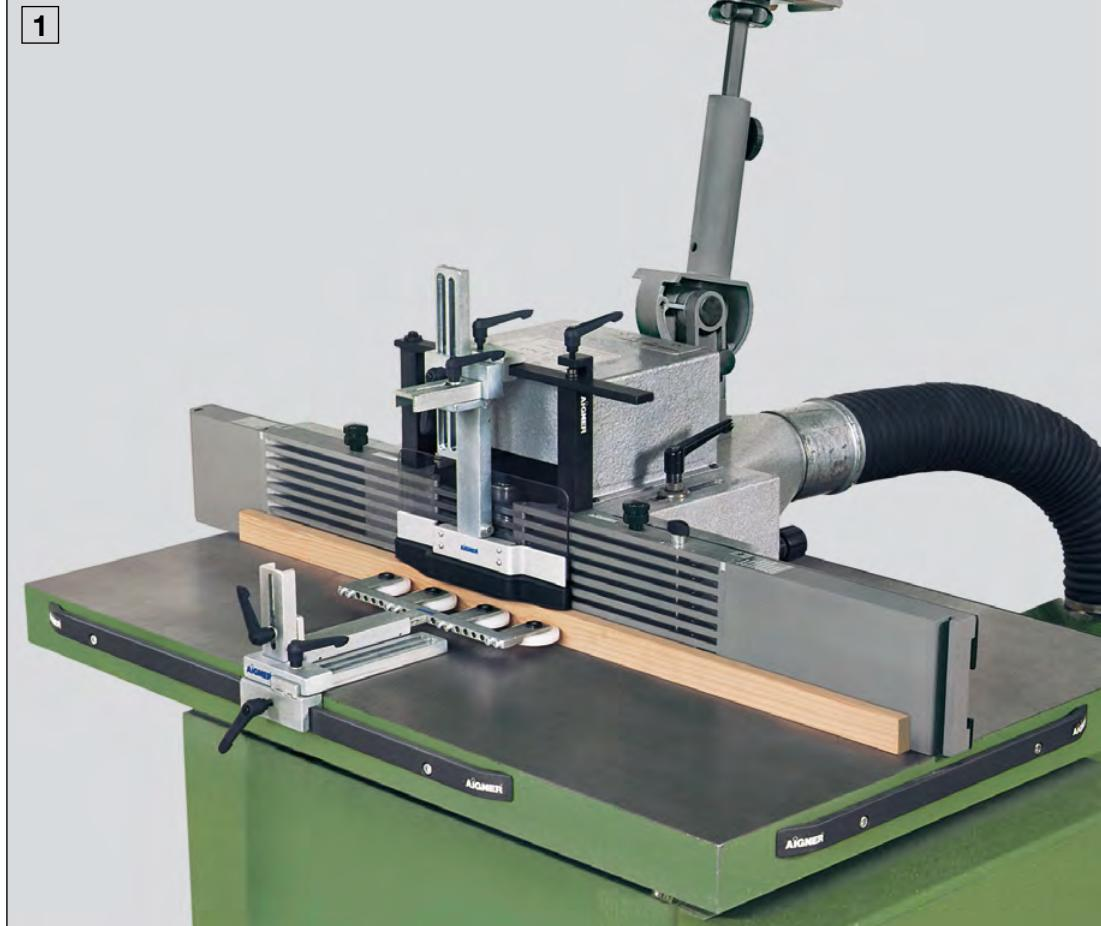
**1** Fraisage d'une pièce mince avec Modules-Presseurs 1, Patin-Guide et Galet-Quadruple.
