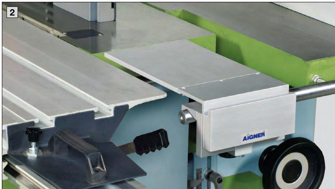
**1** Adaptateur de fixation
