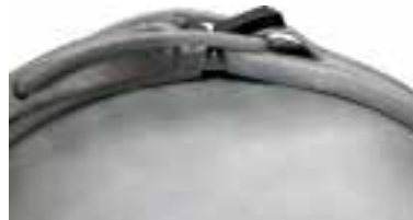
6 Vergrendel de QF verbindingklem over de rubberen ring en één uiteinde van de buisafronzing.
