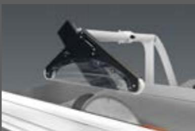
Overhangende zaagkap met geïntegreerde buis voor stofafzuiging
