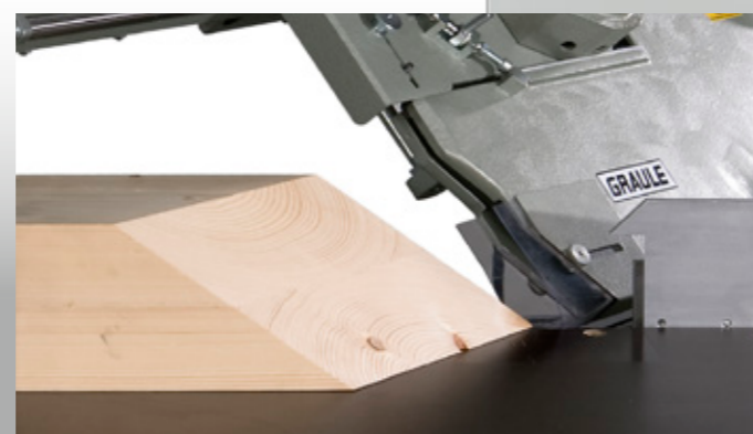
Maximale balkafmetingen tot 200 x 420 mm (optie tot 500m) Houtlengtes tot 8,5 m standaard (optie tot 15m)
