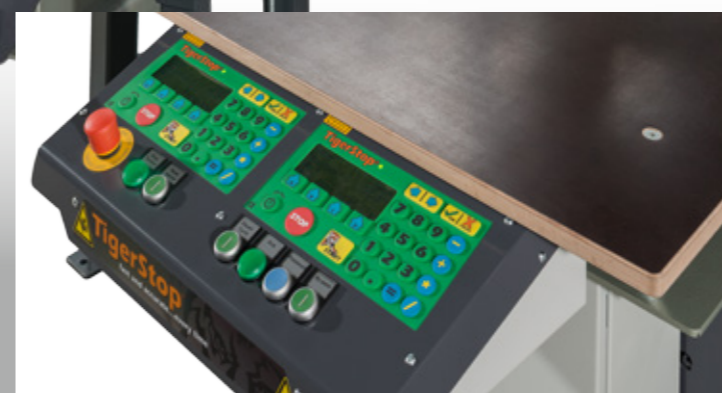
Automatische hoekinstelling met Tigerstop servo drive systeem Tot 0.05 graad precisie
