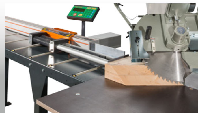
Automatisch positionering met Tigerstop opduwer
