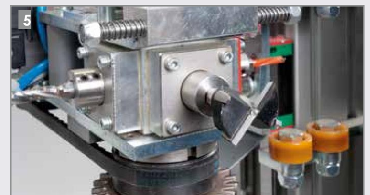
Boor van 35 mm voor potscharnieren
