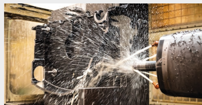
CNC gestuurde bewerkingen op de gietijzeren zaagbeugel
