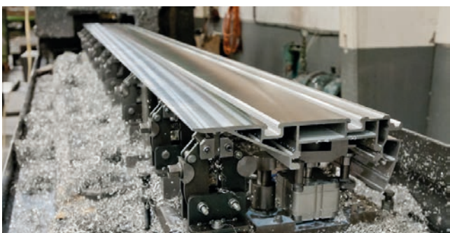
Frezen van de oppervlakte van de loopwagen
