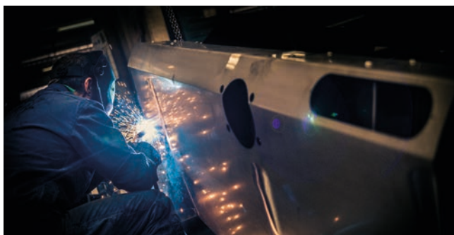
Lassen van een chassis
