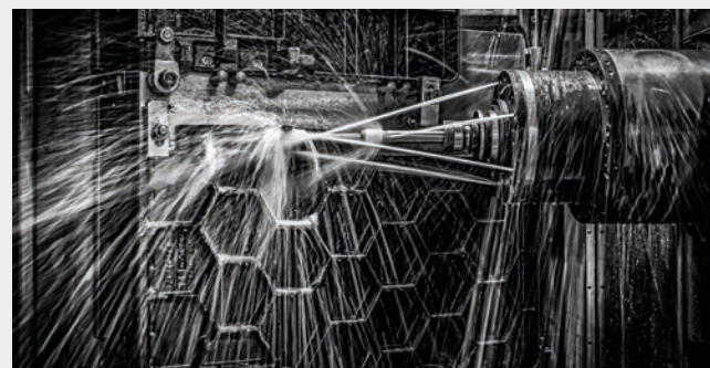
CNC gestuurde bewerkingen van de gietijzeren tafels
