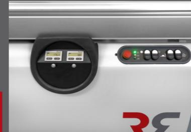
Bedieningspaneel Z400 EL met optionele digitale aflezing van hoogte en hoek van het zaagblad voor meer comfort en een hogere precisie.
