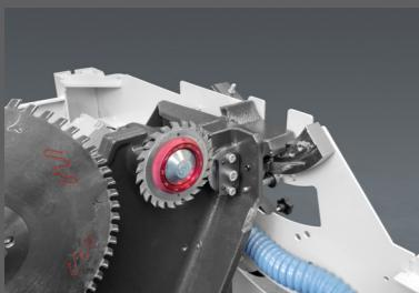
Het zware, gietijzeren zaagaggregaat draait op grote schelpen. Het systeem is onderhoudsvrij en waarborgt levenslange nauwkeurigheid en soepele bewegingen. Het toerental is eenvoudig te veranderen. Er is een ruim aanbod aan motorvermogenen.
